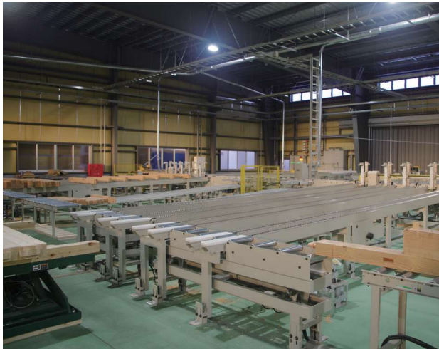
手前が6m仕様、奥が8m仕様の取出搬出口
