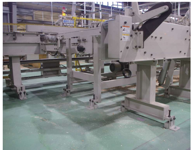
エアブローで清掃できるよかさ上げされた脚部
