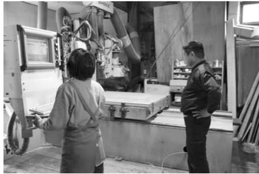
三次元CADのデータ通りにNCルーターで加工する
