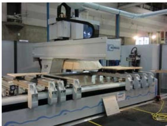
【写真】ホマッグジャパンが木機展・名古屋に出展した機種のひとつで、マシニングセンターという種類の機械。こうした複数種の機械をシステマ的につなぎ、ワンバッチ（一品対応）でワークセル（システム）を動かす。
