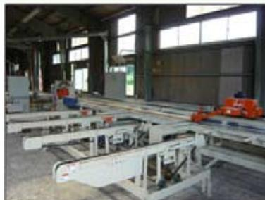
20%)で、賃貸住宅向けを主体とする2×4プレカット事業部門の生産効率を向上させる目的で、今回新たにCAD/CAM対応の墨付け機能付2×4プレカットラインを配備させたもの。
