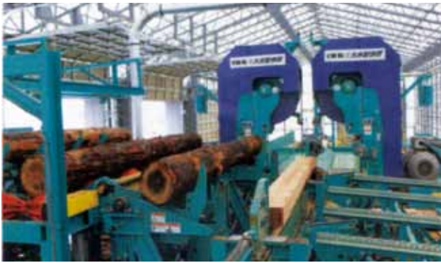
ツインバンド製材機とプレカット複合ラインを新設
