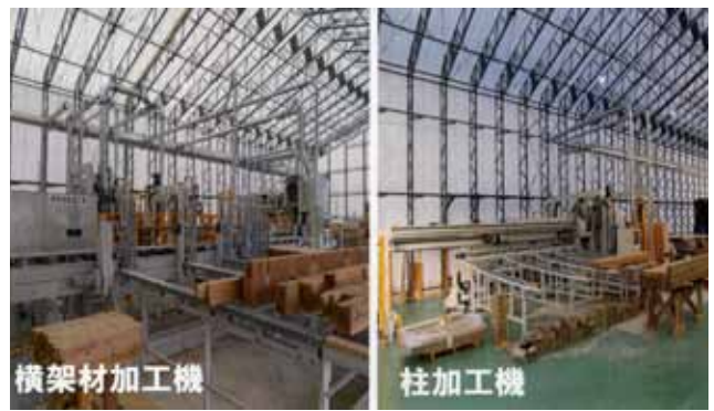
ATAハイブリッド構法の全自動プレカット加工システムを全国で初めて導入
