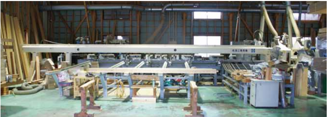
坂詰プレカットセンターにある柱加工機
