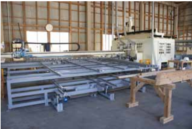
ユニバーサルカットソー（平安製）で羽柄の加工
