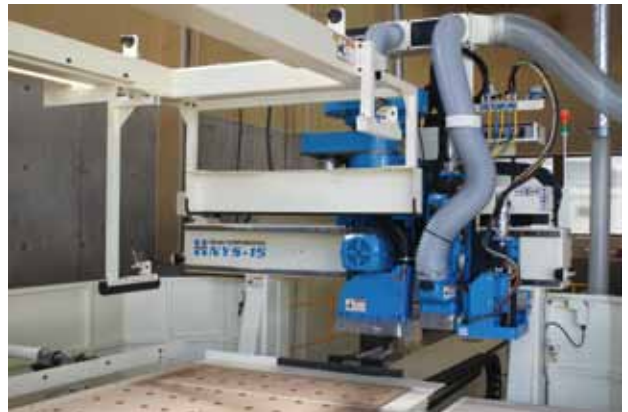
野地板・床パネル加工機 サイディング加工も可能
