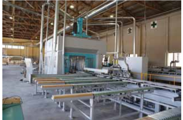
5軸加工機（平安製）で仕口等の加工
