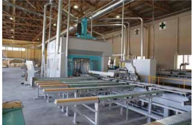
5軸加工機（平安製）で仕口等の加工
