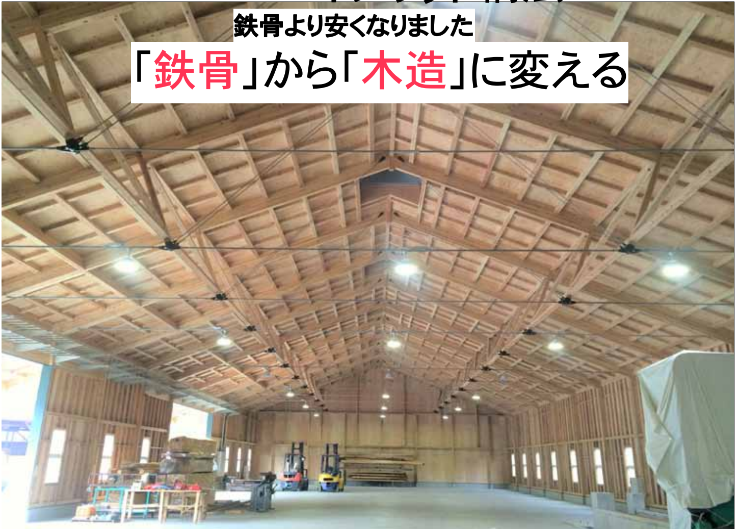
黒田木材商事(株)一般流通サイズの地域材杉を使用した大型製材工場(19M*51M)
