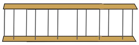
ライト兄弟が考案した世界初の飛行機の翼部分(略図)。圧縮方向は木で支え、引張方向はスチールで支える。
